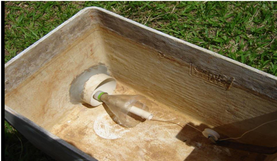
**Figura 6. Detalhe da parte de uma garrafa PET para atuar como um plug no interior da tubulação e promover a saída de água aos sulcos.**
